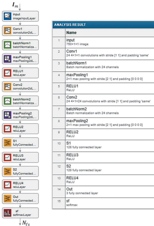
Рис. 9. Архитектура и параметры CNN-классификатора
