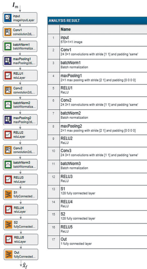
Рис. 5. Архитектура и параметры CNN для ОМП на ВЛ
